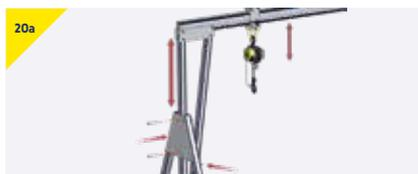
**Boulons de réglage de la hauteur de la poutre (2 boulons par montant). Serrez tous les boulons à 27 Nm (20 pieds-livre) ou jusqu'à ce que les rondelles élastiques soient complètement comprimées.**
