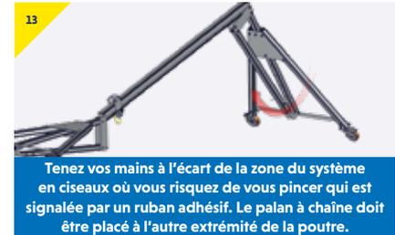
**Tenez vos mains à l'écart de la zone du système en ciseaux où vous risquez de vous pincer qui est signalée par un ruban adhésif. Le palan à chaîne doit être placé à l'autre extrémité de la poutre.**
