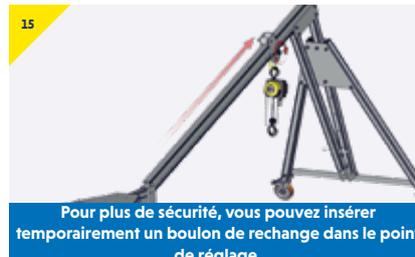
**Pour plus de sécurité, vous pouvez insérer temporairement un boulon de recharge dans le point de réglage.**
