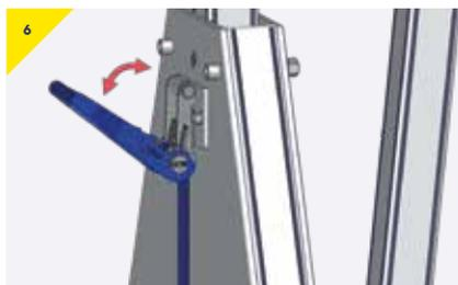
➤ Utilisez la sangle à cliquet pour ajuster la hauteur au réglage requis, en veillant à ce que les trous des boulons soient correctement alignés.
