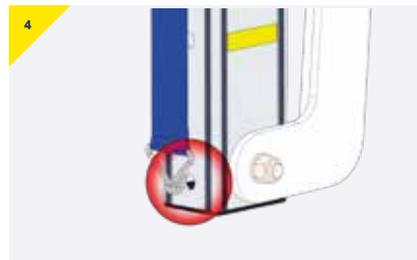
➤ Assurez-vous que le crochet à l'extrémité de la sangle à cliquet est bien engagé dans le trou inférieur du montant du pied en A.
