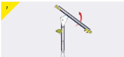
Dans certaines circonstances, le treuil peut être utilisé pour faire pivoter la poutre et l'aligner pour insérer la goupille.
